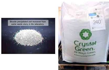
<그림 17> 축산분뇨로부터 회수한 struvite(左) 및 폐수로부터 회수한 struvite를 브랜드화 시켜 상품화 한 예(右).
